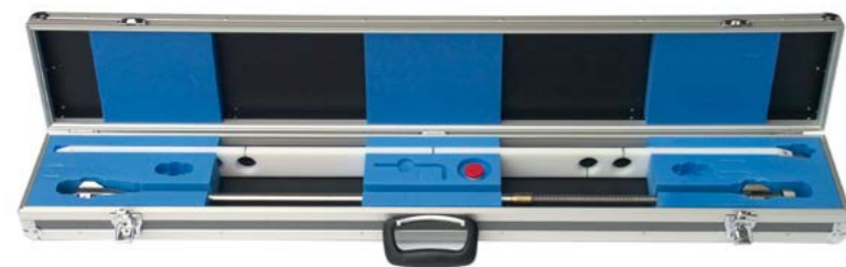
滑动测微计，带导向节，至于携带箱中
