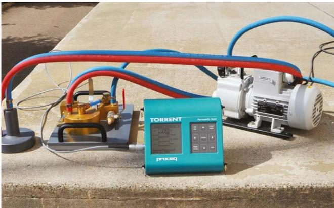
**Torrent** : “混凝土保护层”是用于保护钢筋免受会引起腐蚀的侵蚀性成分影响的混凝土分层。Proceq 的透气性检测仪 Torrent 提供一种快速、可靠和无损的混凝土结构透气性测量方法。Torrent 可依照瑞士标准 SIA 262/1 在现场对“混凝土保护层”的质量进行完全无损的检测。利用 Torrent 来测量混凝土透气性只需 2 至 12 分钟。由于 Torrent 采用独特的显示屏,在测量之后可轻松分析透气性数据。
