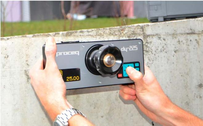
在建筑行业中，拉拔或附着力（粘合）测试是应用最广的一种测试方法。但是，众所周知，操作员在检测过程中应用负载造成的影响对于检测结果的可重复性和可靠性有着重大影响。Proceq DY-2 由于使用集成的反馈控制电机，确保采用能证实的一致负载率，使拉拔测试仪自动化，完成消除操作员影响。此外，Proceq DY-2 系列涵盖了整个拉拔应用范围，它拥有无可比拟的操作便利性和存储所有检测程序记录的能力。
