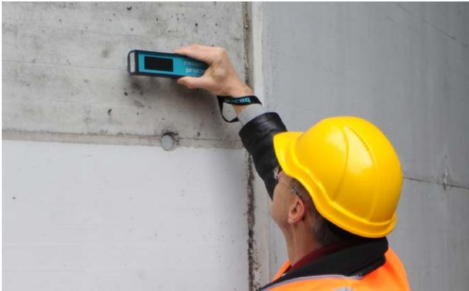
**Resipod** : 建筑行业越来越注重新建筑物混凝土耐久性的规范;同时,实际钢筋混凝土的使用寿命评估也日益增长。多年来,不管是在新结构还是现有结构中,混凝土电阻率一直被当作确定混凝土品质的关键参数。Resipod 是世界上功能最齐全的混凝土表面电阻率检测仪,用于实验室和现场检测,以便评估耐用性、均匀性和腐蚀。
