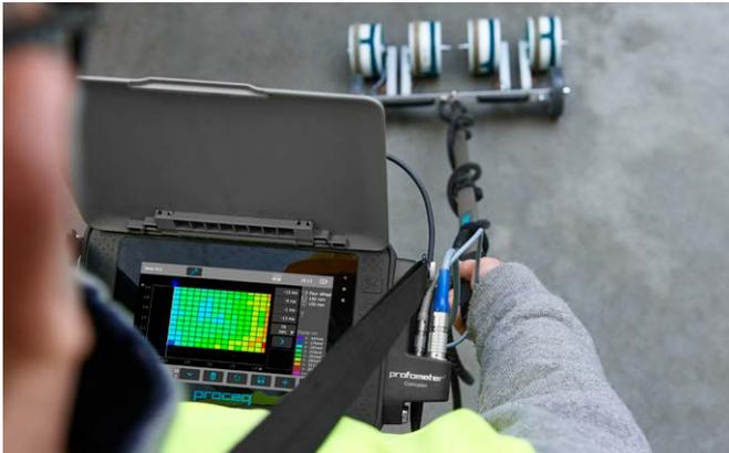
带 4 轮电极的 Profometer Corrosion
